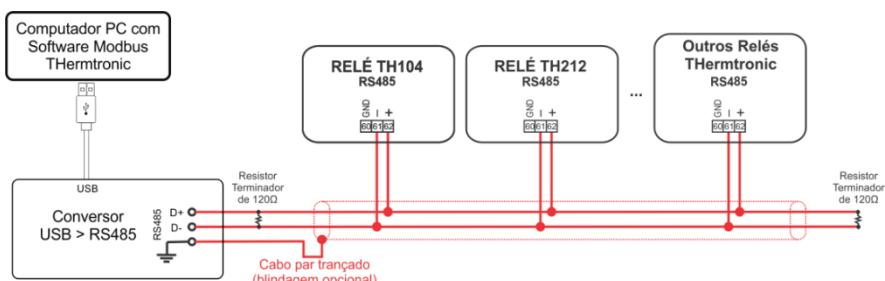
Uma vez conectado, o primeiro passo é configurar a velocidade de comunicação e o endereço em todos os dispositivos conectados. Para configurar a velocidade nos controladores TH104IoT e TH212IoT, pressione a tecla “P”, escolha as opções “Configuração de Rede”, “Configurar Modbus”, “Habilitar=SIM” e então selecionar a Velocidade e o endereço de cada dispositivo.
