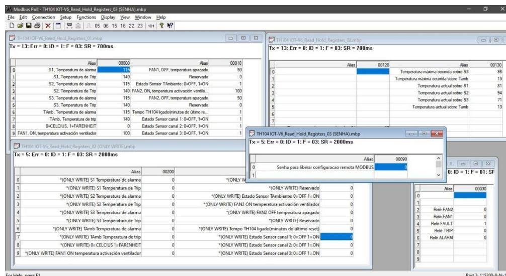
A tecla “Alt + F5” pode ser utilizada para gravar “On” no registro 48 (030 H), Reset das temperaturas máximas (Tmax) da memória.
