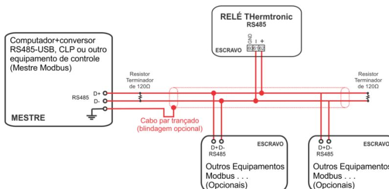
Os controladores THermtronic vêm com uma porta RS485 permitindo, como dispositivo escravo, o intercâmbio de dados através do protocolo Modbus® RTU com um dispositivo mestre como um sistema Scada, CLP, computador PC ou com o software gratuito (para sistemas Microsoft Windows) fornecido pela THermtronic aos nossos clientes.
