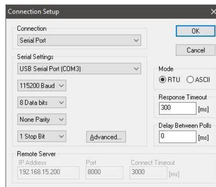
A tela abaixo mostra um exemplo de tela, e comunicação com o controlador TH212IoT. A telha “F8” poderá ser utilizada para Configurar cada janela de comunicação independentemente.
