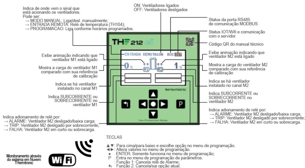
O primeiro passo para o funcionamento do TH212IoT após a instalação ou após efetuado qualquer ajuste nos ventiladores, é executar a calibração através do menu.
