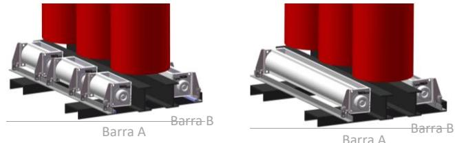
✓ **IMPORTANTE!** - Os sistemas de ventilação TH440 e TH450 podem ser fixados a base (opção 1) ou ao suporte das bobinas (opção 2) do transformador por meio de parafusos passantes, porcas e arruelas (dependendo do tamanho e da quantidade de ventiladores na barra). Os parafusos recomendados variam entre M8 e M14)
