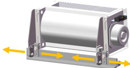
✓ **IMPORTANTE!** - Regular a posição de centralização dos ventiladores em relação às bobinas, ajustando dois parafusos.
